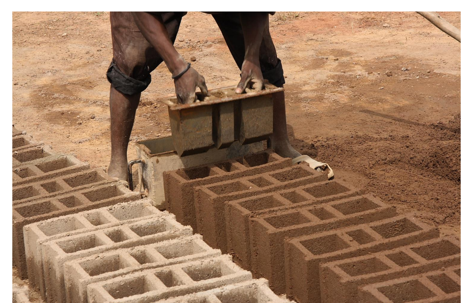
Foto 8: Herstellung der Zementziegel in Taon
